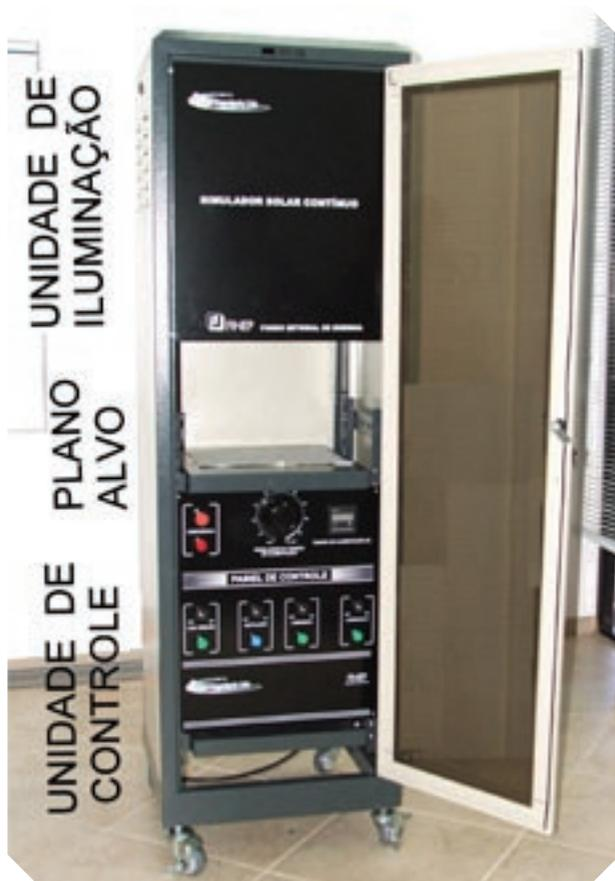
**Figura 7:** Primeiro simulador solar desenvolvido e comercializado no Brasil (SOLSIM). Projetado em parceria pelo INPE/Orbital e comercializado pela empresa Orbital Eng. Ltda., sediada em São José dos Campos, SP.
